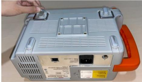
**PERINGATAN!** Sebelum membuka casing lebih dari satu inci pada langkah berikutnya, lepaskan tabung dari transduser tekanan pada sambungan. Kegagalan untuk melepaskan tabung dapat menyebabkan kerusakan pada transduser atau tabung.
